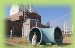
東浜第1・2・3ポンプ 第3ポンプ口径1800mm・第1口径2200mm
